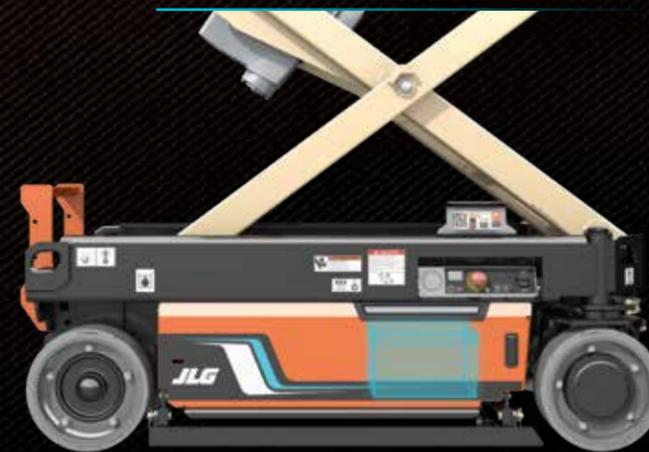
UNA SOLA BATERÍA DE IONES DE LITIO
